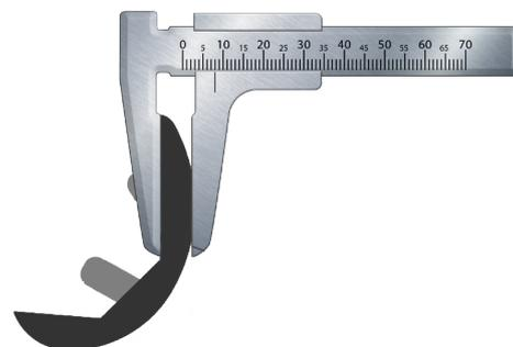
En fonction de l'épaisseur distale mesurée, sélectionnez l'épaisseur distale K-MOD UNI REV 4÷9 mm (300110794÷9) appropriée.
